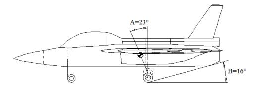
Figure 22: Longitudinal criteria
